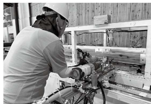
機械打ちのビスでパネルを留め付ける
